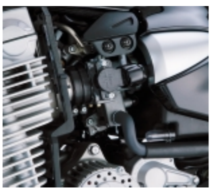
Die Einspritzung mit Doppeldrosselklappen liegt hinter einer Blende hitzegeschützt.
